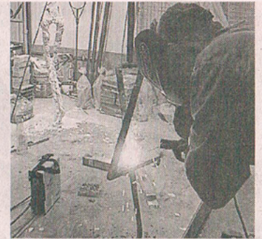
Deuxième étape. La mise en place des armatures métalliques permettant le respect des proportions entre les membres et les positions des personnages. Au fond, une des structures métalliques est déjà couverte par des bandes plâtrées pour donner un premier volume au corps. Ensuite le plâtre sera couvert par la terre et le façonnage des corps commencera.
